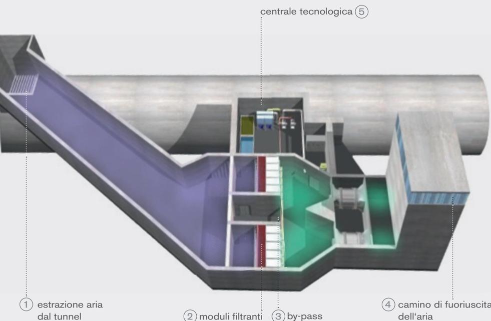
Particelle dannose sono specificamente rimosse prima della fine del tunnel ①, così che non possano essere rilasciate in ambiente.
